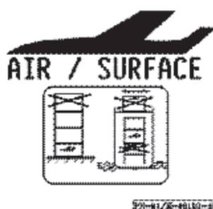
Rysunek 10. Znak kontenera do transportu lotniczego i lądowego o ograniczonej wysokości piętrzenia
